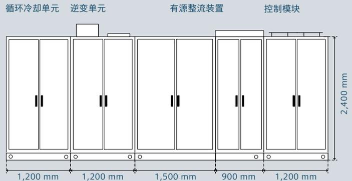
图：SINAMICS SM120 CM 系统配置尺寸图
