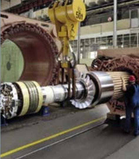
位于挪威哈默菲斯特市的全球第一个全电气化的气体液化系统中：以 3600 rpm 转速运转的 65 MW 压缩机电机
