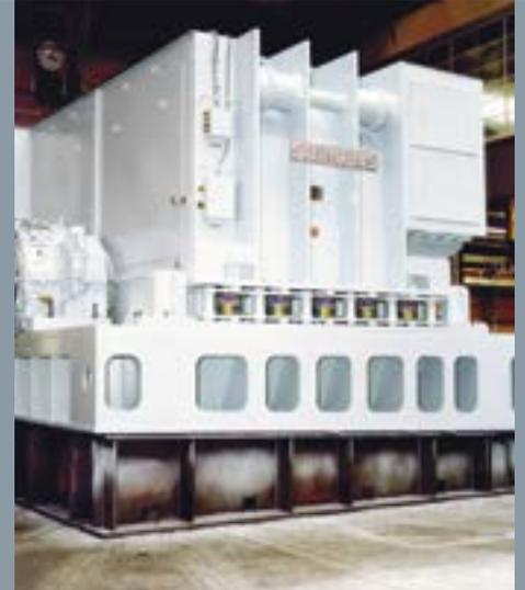
用于一艘游船的主驱动装置的两台 21 MW 电机之一
