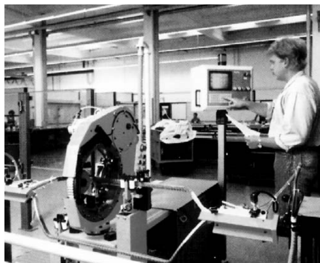
槽部线圈的全自动绝缘
