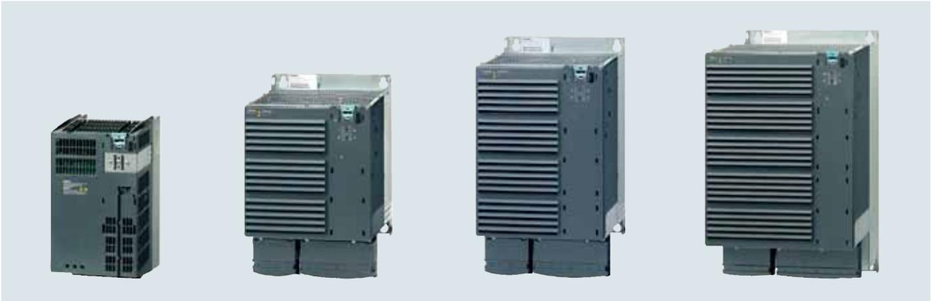
PM250 功率模块在能量再生状态（回馈制动）下能够将能量回馈的能力意味着能够将再生能量回馈给电网，而不是消耗在制动电阻上。这样不仅节省了柜体的安装空间，同时，也节省了接线的数量和工程设计和安装调试的时间。采用回馈制动还可以减少柜体内的散热。
